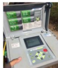
3. เครื่องมือทดสอบค่าความต้านทานของหม้อแปลงไฟฟ้า
